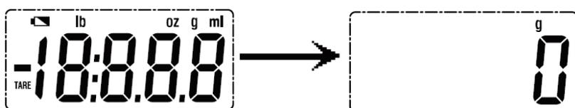
2. Поместите емкость на весы. На дисплее отобразится вес емкости.
