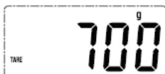
5. После извлечения продукта из емкости для взвешивания на дисплее снова отобразится «0». Однако после удаления емкости с платформы весов на дисплее отобразится вес емкости с отрицательным значением.
